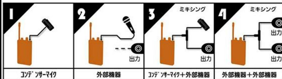
マイク/ 外部入力切替スイッチと付属のミキシング接続コードを併用することで実現。
